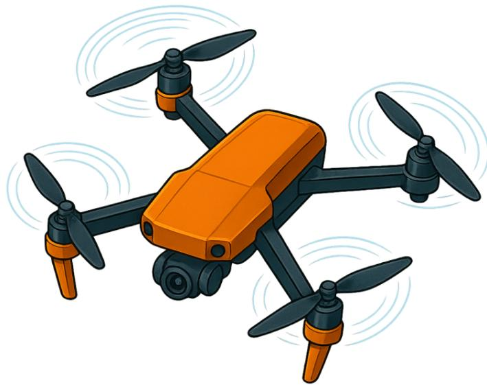
**Multirroto:** Tipo de dron con varias hélices (p. ej.: 4), que puede elevarse y quedarse quieto en el aire.
